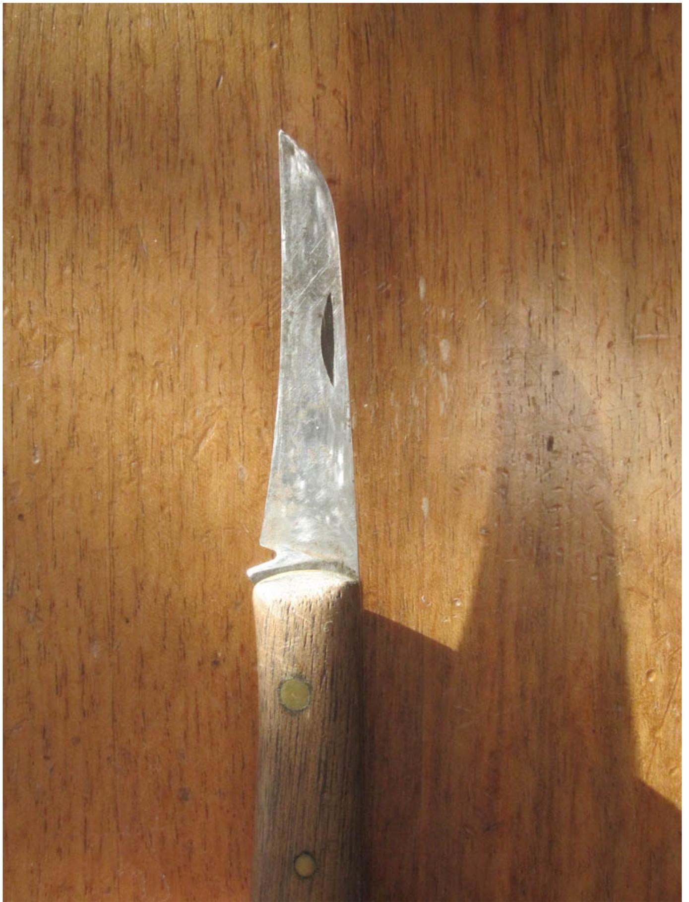
Die Messer der Bilder oben sind alle alt und stark gebraucht. Links ist ein Geißfußmesser, mit dem der Schnitt in der Unterlage gemacht wird. Der [Geißfuss](#) lässt sich mit Geschick aber auch mit der Kopulierhpe machen, aber dazu sollte es eine mit geschwungener und nicht gerader Klinge sein, wie oben rechts. Die Bilder rechts zeigen eine alte Kopulierhippe, die schon oft nachgeschliffen wurde und deren Klinge bald schon zu klein ist für weitere Veredelungen.
